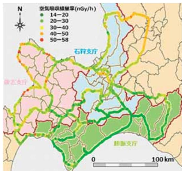
図7 道央の走行サーベイによる空気吸収線量率マップ
