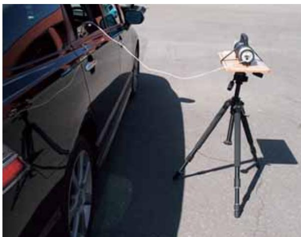
図3 車外の地表面から1mにおける線量率測定
